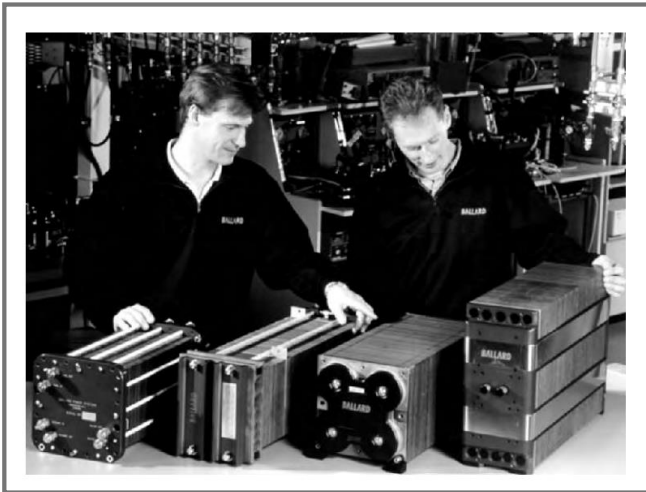
Figura 8. Stacks de PEM-FCs desarrollados por Ballard Power Systems. (de 100 W l -1 a 1,1 kW l -1 )
